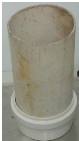
Figura 4 – Molde para corpo de prova após lubrificação com vaselina industrial.
