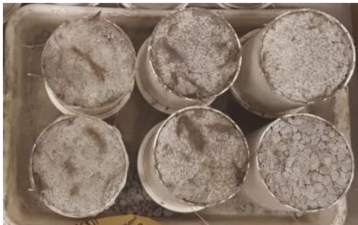
Figura 7 - Disposição dos corpos de prova após moldagem.
