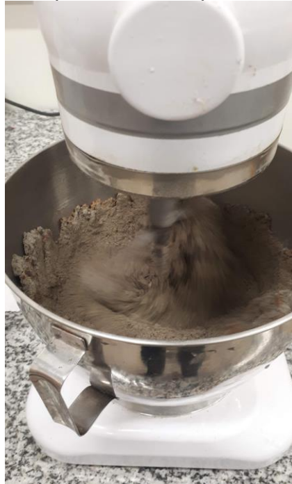
Figura 5 – Mistura sendo batida em argamassadeira.
