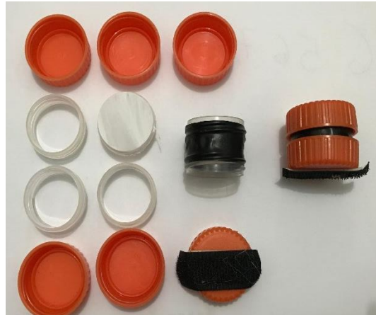
Figura 01: Amostrador passivo confeccionado para pesquisa Fonte: Autora do trabalho
