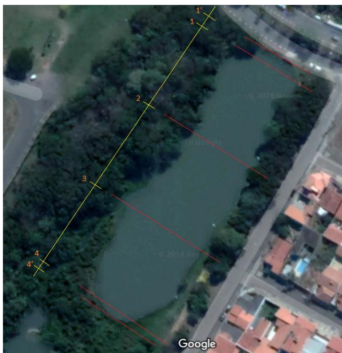
Figura 1: Localização e marcação das medidas realizadas para levantamento batimétrico do córrego do Andrezinho, Araras - SP
