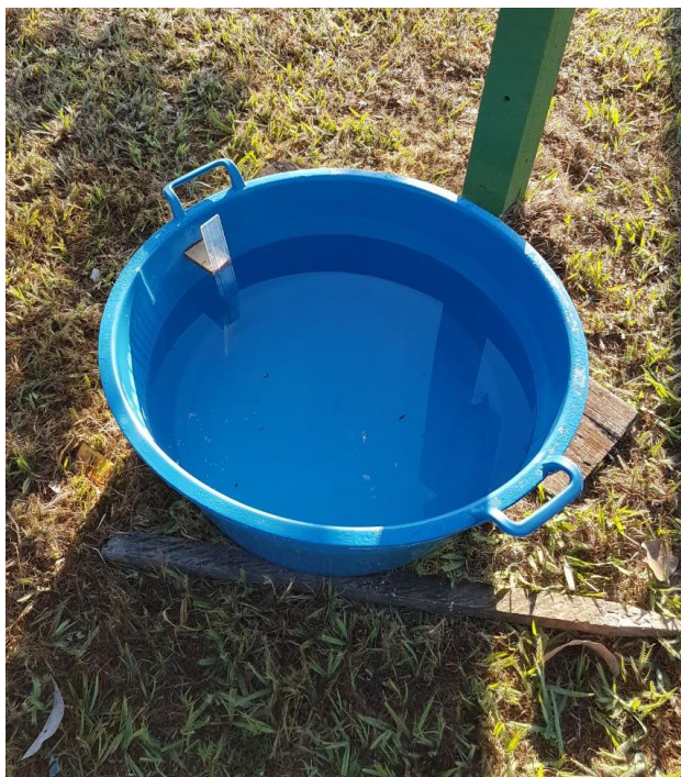
Figura 2: Adaptação de evaporímetro do tipo Tanque de Evaporação.
