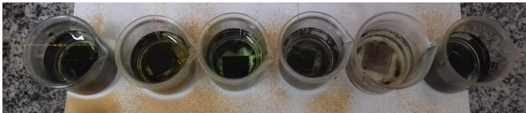
Figura 7. Placas após 120 horas no ácido clorídrico.
