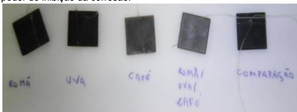
Figura 9. Foto das placas após a corrosão de 24 horas.
