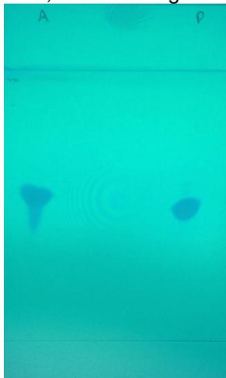
**Figura 1:** Placa cromatográfica de identificação da matéria prima cetoconazol.
