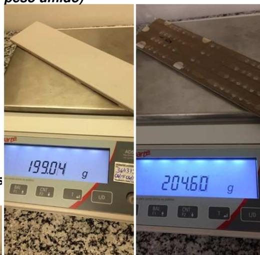
Figura 3 – Concreto (peso seco e peso úmido)
