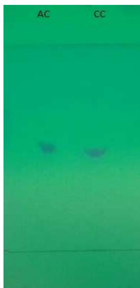
**Figura 2:** Placa cromatográfica de identificação do comprimido de cetoconazol desenvolvido em relação a um comprimido comercial.
