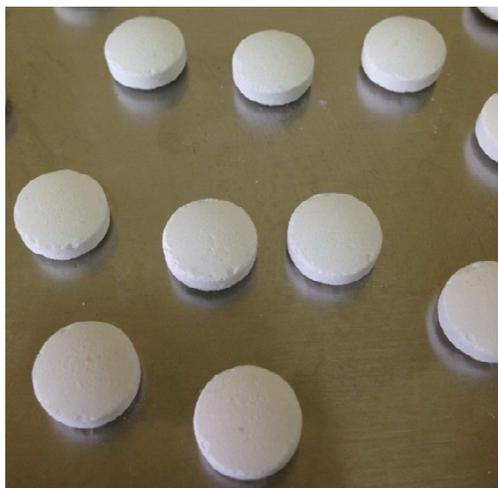
**Figura 3:** Comprimidos após o teste de friabilidade. Fonte: dos autores.
