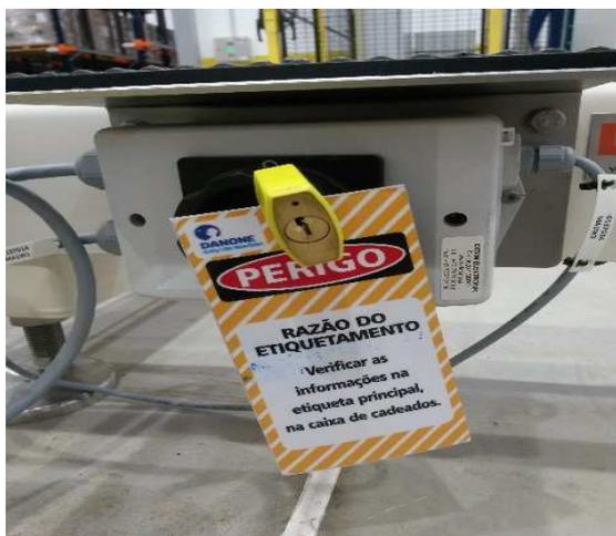
**Figura 3** – Exemplos de dispositivo com travamento e etiquetagem.
